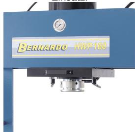
Hartverchromter Kolben aus vergütetem Spezialstahl.
