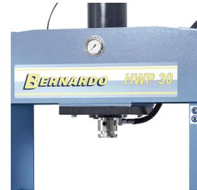
Hartverchromter Kolben aus vergütetem Spezialstahl.
