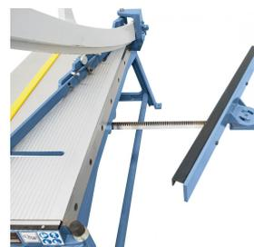
Verstellbarer Hinteranschlag für erweiterten Einsatzbereich.
