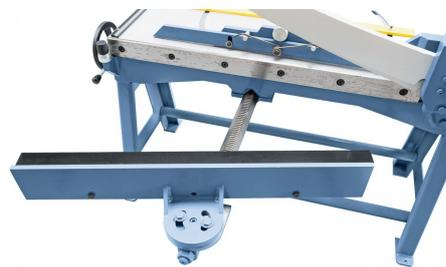
Verstellbarer Hinteranschlag für erweiterten Einsatzbereich.
