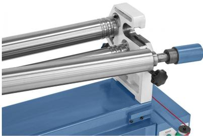
Nach vorne auschwenkbare Oberwalze zur leichten Entnahme des fertigen Werkstückes.
