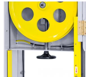
Die Einstellung der Blattspannung erfolgt mittels Handrad.
