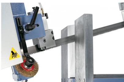
Die kugelgelagerte Sägebandführung sowie die höhenverstellbare Spänebürste sorgen für eine lange Lebensdauer des Sägebandes.
