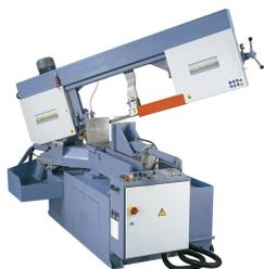
Der beidseitig schwenkbare Sägebügel ermöglicht Gehrungsschnitte bis 60°.
