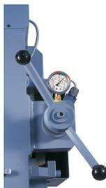
Ein exaktes Einstellen der richtigen Sägebandspannung erfolgt über das serienmäßige Manometer.
