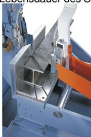
Sägebandführung mit Schnellverstellung zum Anpassen an die Werkstückbreite garantiert ein optimales Schnittergebnis.
