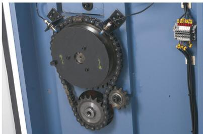
Der robuste Kettenantrieb sorgt für ein exaktes Verfahren der Oberwange und Klemmen des Werkstückes.
