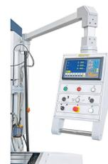
Übersichtlich aufgebautes Elektropaneel. Eine digitale Positionsanzeige in allen 3-Achsen ist im Lieferumfang enthalten.
