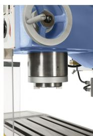
Großdimensionierte Pinole gewährleistet höchstmögliche Stabilität
