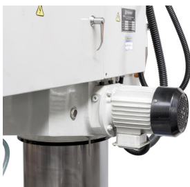
Serienmäßiger Hydraulikmotor für die Klemmung des Auslegerarms und des Bohrkopfes
