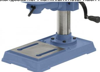
Bearbeitete Bodenplatte zum Aufspannen größerer Werkstücke
