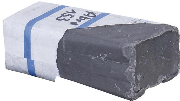
Die „ABRA“ ist eine Schleif- und Bürstpaste zum Mattieren und Satinieren sämtlicher Metalle. Sie enthalten häufig als besonders standfestes Schleifkorn den Elektrokorund, der durch das Schmelzen von Bauxit im elektrischen Lichtbogen bei über 2000° C gewonnen wird.
