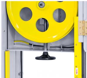
Die Einstellung der Blattspannung erfolgt mittels Handrad.
