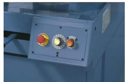
Komfortable Einstellung des Auflagedrucks mittels Regelventil.
