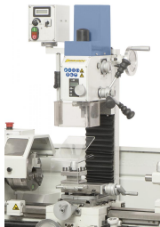
Erweiterter Einsatzbereich durch den nachrüstbaren Fräsaufsatz (Option)
