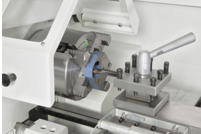
Planscheibe 160 mm (Option) ideal zum Aufspannen von asymmetrischen Werkstücken
