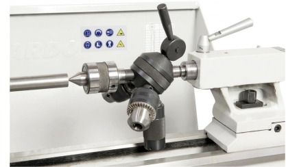
Zum wirtschaftlichen Arbeiten kann die Maschine mit einem Revolverkopf ausgestattet werden
