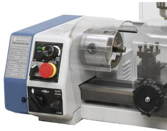
Schaltelemente (Drehzahlregelung, Wahlschalter, Vorschub, ...) am Spindelstock angebracht
