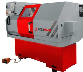
Die HOLZMANN CD3675PRO Metalldrehmaschine mit Siemens 808D Advanced Steuerung, 6fach Werkzeughalter und hydraulischem Spannfutter und manuellen Reitstock mit 750 mm Spitzenweite die perfekte Maschine für ihren Metallbearbeitungsbetrieb oder Ausbildungslehrwerkstatt.
