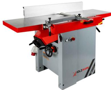
Die HOLZMANN HOB410ECOSMW2\_400V Abricht-Dickenhobelmaschinen mit 410mm Hobelbreite (405mm Dickenhobel), Abricht-Dickenhobelfunktion, Spiralmesserwelle und optional mit Verlängerungstisch sollte in ihrer Holzwerkstatt nicht fehlen. Sehr einfaches Umrüsten von Abricht auf Dickenhobel bzw. Dickenhobel auf Abricht.
