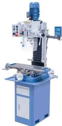
Das Modell BF 30 G ist eine kostengünstige Bohr- und Fräsmaschine. Durch die Schwalbenschwanzführung des Getriebekopfes wird ein Höchstmaß an Präzision und Stabilität gewährleistet. Ihren Einsatzbereich findet dieses Modell hauptsächlich beim Heimwerker.
