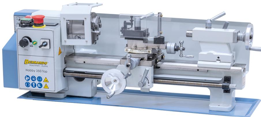
Die Tischdrehmaschine Hobby 350 Top bietet durch den bürstenlosen Gleichstrommotor eine hohe Laufruhe sowie einen gleichmäßigen Antrieb der Spindel. Zur Reduzierung der Fertigungszeiten kann dieses Modell mit einer 2-Achs-Digitalanzeige geliefert werden.
