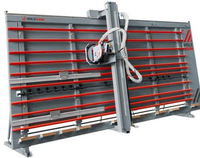
Die HOLZMANN Vertikalplattensäge VPS3216ECO\_230V ermöglicht es Platten mit 3,2m horizontal und 1,6m vertikal zu bearbeiten. Manuell verschiebbarer Lattenrost für eine sichere Bearbeitung in horizontaler Schnittrichtung. Zwei mechanische Anschläge für untere und mittlere Plattenauflage. Die mittlere Plattenauflage ist schwenkbar. Das Sägeaggregat ist die HOLZMANN Tauchsäge TAS165Pro.
