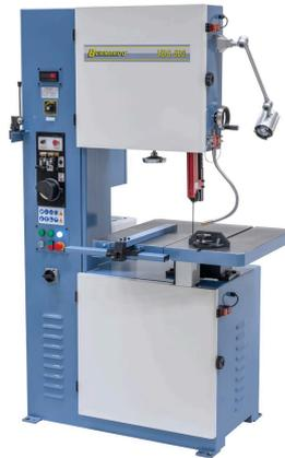
Die Vertikalbandsägen der VBS-Serie eignen sich zum Sägen von nahezu allen sägbaren Materialien (zB. Stahl, Kunststoff, NE-Metalle, Buntmetalle, ...). Ihren Einsatzbereich finden sie vorwiegend in der allgemeinen Produktion, im Werkzeug- und Vorrichtungsbau, bei der Herstellung von Stanz- und Schnittwerkzeugen.
