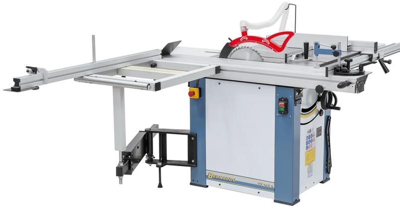
Die Formatkreissäge TK 315 P ist je nach Anwendung wahlweise mit drei verschiedenen Tischlängen lieferbar (1600 / 1800 / 2000 mm). Serienmäßig ausgestattet mit einem 3,0 kW Motor und einem Sägeblatt mit 315 mm Durchmesser für Schnitthöhen bis 100 mm, sowie einem Vorritzaggregat für ein ausreißfreies Bearbeiten beschichteter Plattenwerkstoffe.
