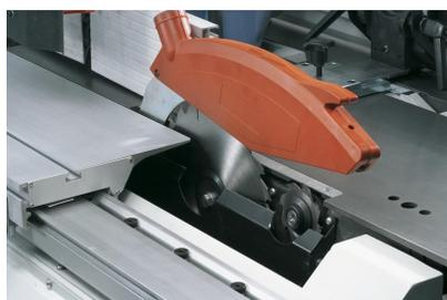
Der Sägeblattschutz mit integriertem Absaugstutzen ist am Spaltkeil befestigt. Serienmäßig mit Vorritzaggregat ausgestattet
