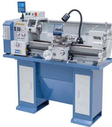
Die Drehmaschine Hobby 800 G ist serienmäßig mit einer Leit- und Zugspindel zum Gewindeschneiden bzw. für den automatischen Längs- und Planvorschub ausgestattet. Durch das 12-Stufen-Schaltgetriebe wird ein schnelles Einstellen der Drehzahlen ermöglicht - kein Keilriemenwechsel notwendig. Durch ihre kompakte Bauweise und das hohe Eigengewicht bietet diese Maschine eine hohe Laufruhe und garantiert dadurch präzises Arbeiten.
