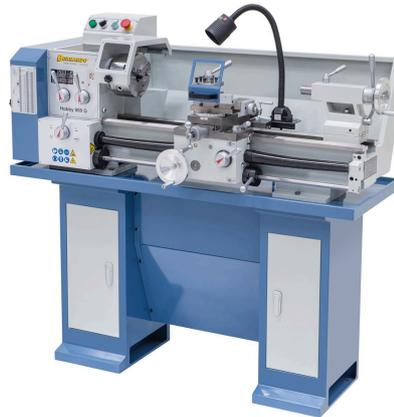
Die Drehmaschine Hobby 800 G ist serienmäßig mit einer Leit- und Zugspindel zum Gewindeschneiden bzw. für den automatischen Längs- und Planvorschub ausgestattet. Durch das 12-Stufen-Schaltgetriebe wird ein schnelles Einstellen der Drehzahlen ermöglicht - kein Keilriemenwechsel notwendig. Durch ihre kompakte Bauweise und das hohe Eigengewicht bietet diese Maschine eine hohe Laufruhe und garantiert dadurch präzises Arbeiten.
