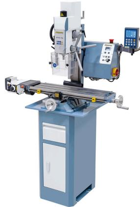
Die Bohr- und Fräsmaschine KF 26 L Top ist serienmäßig mit einem hochwertigem Gleichstrommotor ausgestattet. Wesentliche Vorteile, die sich daraus ergeben, sind das hohe Drehmoment im unteren Drehzahlbereich und die annähernd konstante Drehzahl unter Last. Ihren Einsatzbereich findet dieses Modell hauptsächlich beim professionellen Anwender, im Modellbau, aber auch im Ausbildungsbereich.
