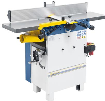
Die kompakte Abricht- und Dickenhobelmaschine PT 310 S - mit einem Dickendurchlass von 180 mm - ist ideal zum exakten Hobeln von Brettern, Leisten und Balken. Durch die optional erhältliche Langlochboheinrichtung können zusätzlich Schlitz- und Bohrarbeiten durchgeführt werden. Die Spiralmesser-Hobelwelle für eine verminderte Lärmbelastung und optimale Hobelergebnisse ist ein weiteres Plus dieser Maschine.
