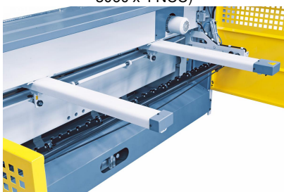
Pneumatische Blechhochhaltevorrichtung, der Anwender kann wahlweise den Blechsauswurf zur Bedienerseite oder zur Maschinenrückseite einstellen.
