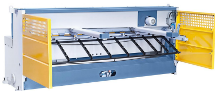
Rückwertige Maschinenansicht mit Schutzblech und Fotozellen. (Abbildung MTR 3060 x 4 NCC)
