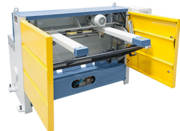
Rückwertige Maschinenansicht mit Schutzblech und Fotozellen. (Abbildung MTR 1360 x 3 NCC)
