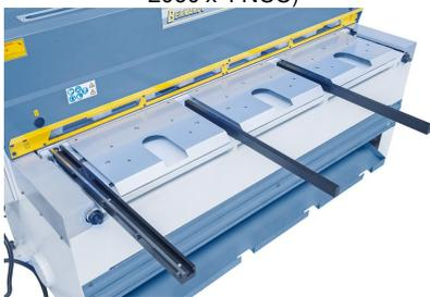
Seitliches Anschlaglineal mit Skala, Kippnocke und T-Nut.
