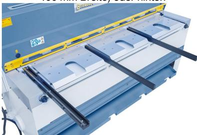
Seitliches Anschlaglineal mit Skala,
