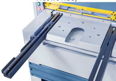
Seitliches Anschlaglineal mit Skala, Kippnocke und T-Nut.
