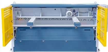
Händisch einstellbare Blechrutsche für wahlweisen Blechwurf nach vorne (bis max. 400 mm Breite) oder hinten (Abbildung MTE 2060 x 3 NCC)
