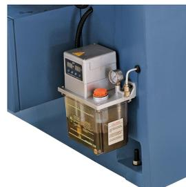
Alle Führungsbahnen und Spindeln werden automatisch geschmiert
