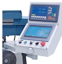
Steuerung mit Touch-Bedienung und elektronisches Handrad.
