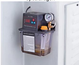
Automatische Zentralschmierung für alle Führungsbahnen und Spindeln.
