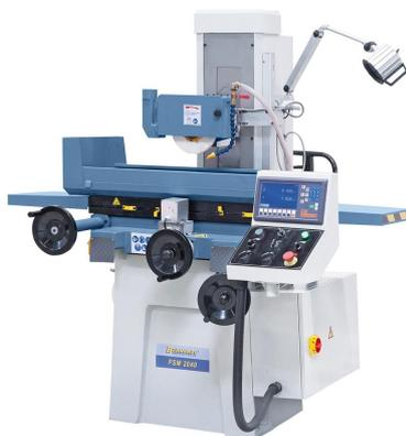
Die FSM 2040 ist eine sehr massiv gebaute Flachsleifmaschine mit kompakten Abmessungen. Durch die einfache Handhabung ist diese Maschine ideal für Schulen, Lehrwerkstätten, aber auch für den Werkzeug- und Formenbau geeignet.
