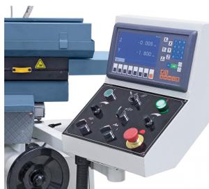
2-Achs-Digitalanzeige mit LCD-Display im Lieferumfang enthalten.
