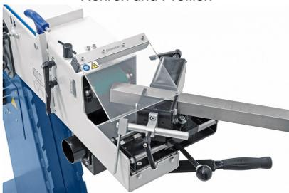
Schwenkbare Schleifeinrichtung von 30° bis 90°
