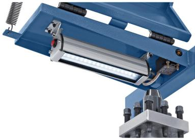
Integrierte LED-Maschinenlampe im
