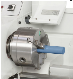
3-Backenfutter in Stahlausführung mit Dreh- und Bohrbacken im Lieferumfang enthalten
