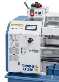
Elektronisch, stufenlose Drehzahlregelung, leichtes Ablesen mittels Digitalanzeige.
