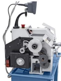
Wechselräder zum Gewindeschneiden im Lieferumfang enthalten.
