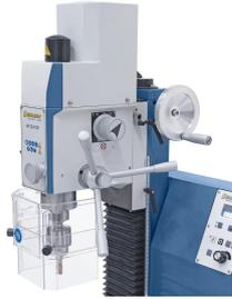
Großdimensionierter Sterngriff für leichte Pinolenzustellung beim Bohren, Handrad für Feinzustellung beim Fräsen.
