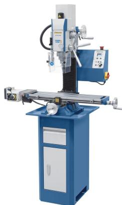
Die Bohr- und Fräsmaschine KF 28 Top ist serienmäßig mit einem hochwertigem Gleichstrommotor ausgestattet. Wesentliche Vorteile, die sich daraus ergeben, sind das hohe Drehmoment im unteren Drehzahlbereich und die annähernd konstante Drehzahl unter Last. Ihren Einsatzbereich findet dieses Modell hauptsächlich beim professionellen Anwender, im Modellbau, aber auch im Ausbildungsbereich.
