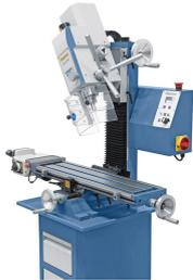
Beidseitig schwenkbarer Fräskopf von  $-90^\circ$  bis  $+90^\circ$ .
