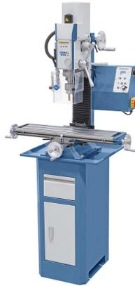
Die Bohr- und Fräsmaschine KF 28 Top ist serienmäßig mit einem hochwertigem Gleichstrommotor ausgestattet. Wesentliche Vorteile, die sich daraus ergeben, sind das hohe Drehmoment im unteren Drehzahlbereich und die annähernd konstante Drehzahl unter Last. Ihren Einsatzbereich findet dieses Modell hauptsächlich beim professionellen Anwender, im Modellbau, aber auch im Ausbildungsbereich.
