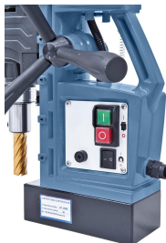
Verwechslungsfreie Anordnung der Schaltelemente.
