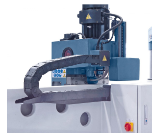
Gegengewicht für die Pinole und Energieführungskette an der Rückseite des Bohrkopfes.
