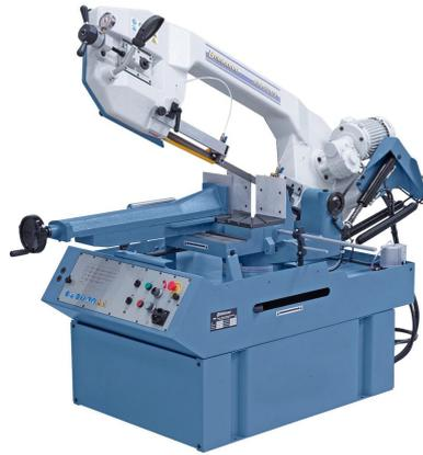
Das Modell MBS 530 DG ist eine präzise Horizontalbandsäge für den universellen Einsatz. Die Merkmale dieser Maschine sind der schwenkbare Sägebügel für Doppelgehrungsschnitte von  $-45^\circ$  bis  $+60^\circ$ , sowie ein Hydraulikzylinder zum feinfühligem Absenken mittels Regelventil. Ihren Einsatzbereich findet diese Maschine in Schlossereien, Reparaturbetrieben, im Formen- und Werkzeugbau, ...
