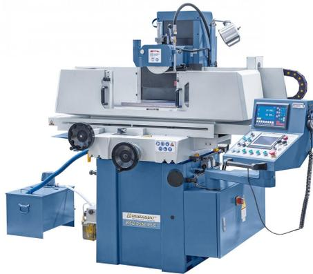
Die massiv gebauten Flachsleifmaschinen der BSG-Serie sind serienmäßig mit einer automatischen Vertikalzustellung ausgestattet. Alle Hauptbaugruppen wie Ständer, Sockel und Schlitten sind aus hochwertigem Guss hergestellt. Durch das umfangreiche Standardzubehör bieten diese Modelle ein optimales Leistungspaket für den Werkzeug- und Formenbau.
