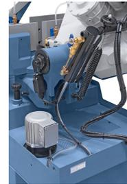
Seriennäßig mit leistungsstarker Kühlmittelpumpe.
